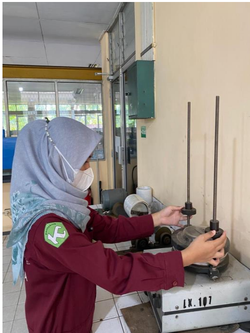
Gambar 24. Penyeragaman ukuran karbon dengan sieving
