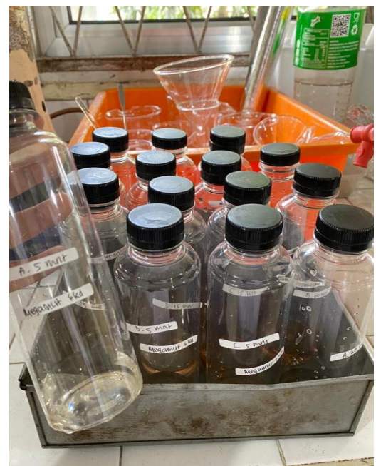
Gambar 37. Sampel yang telah disaring dan diambil filtratnya siap untuk di analisa kandungan Fe menggunakan alat AAS
