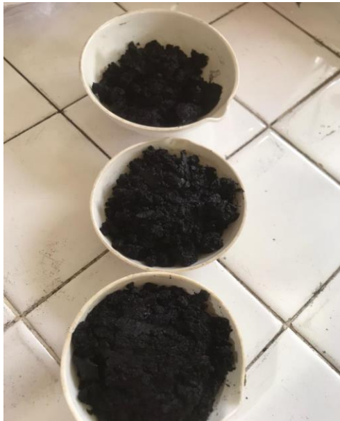
Gambar 28. Setelah dicuci filtrat cukup jernih dan mempunyai pH 7, komposit diambil dan dipisahkan dari filtrat
