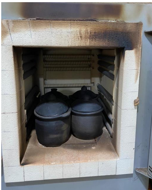
Gambar 20. Proses karbonisasi kulit durian dan kulit singkong pada suhu 500 °C
