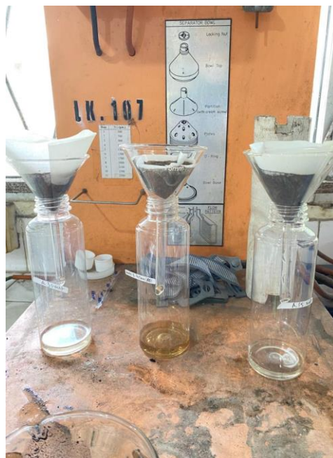
Gambar 36. Penyaringan komposit yang telah dikontakkan dan air gambut diambil untuk di analisa menggunakan alat AAS
