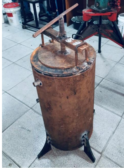
Gambar L3.1 Modifikasi Reaktor Pirolisis
