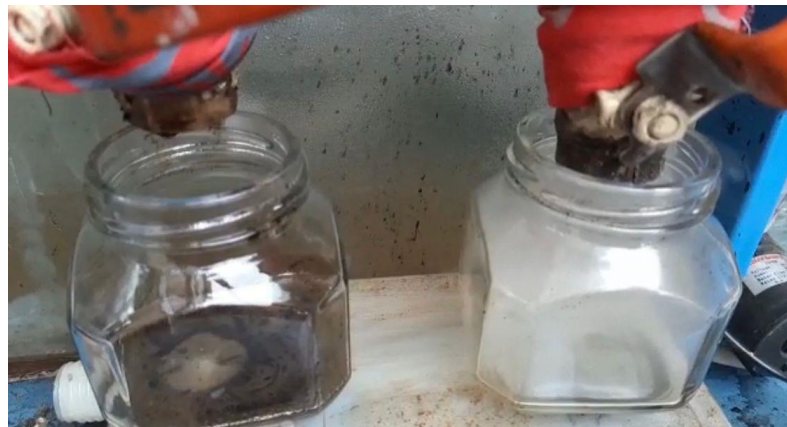
Gambar LIII.10 Tempat Penampungan Asap Cair Pada Kondensor 1 dan Kondensor 2
