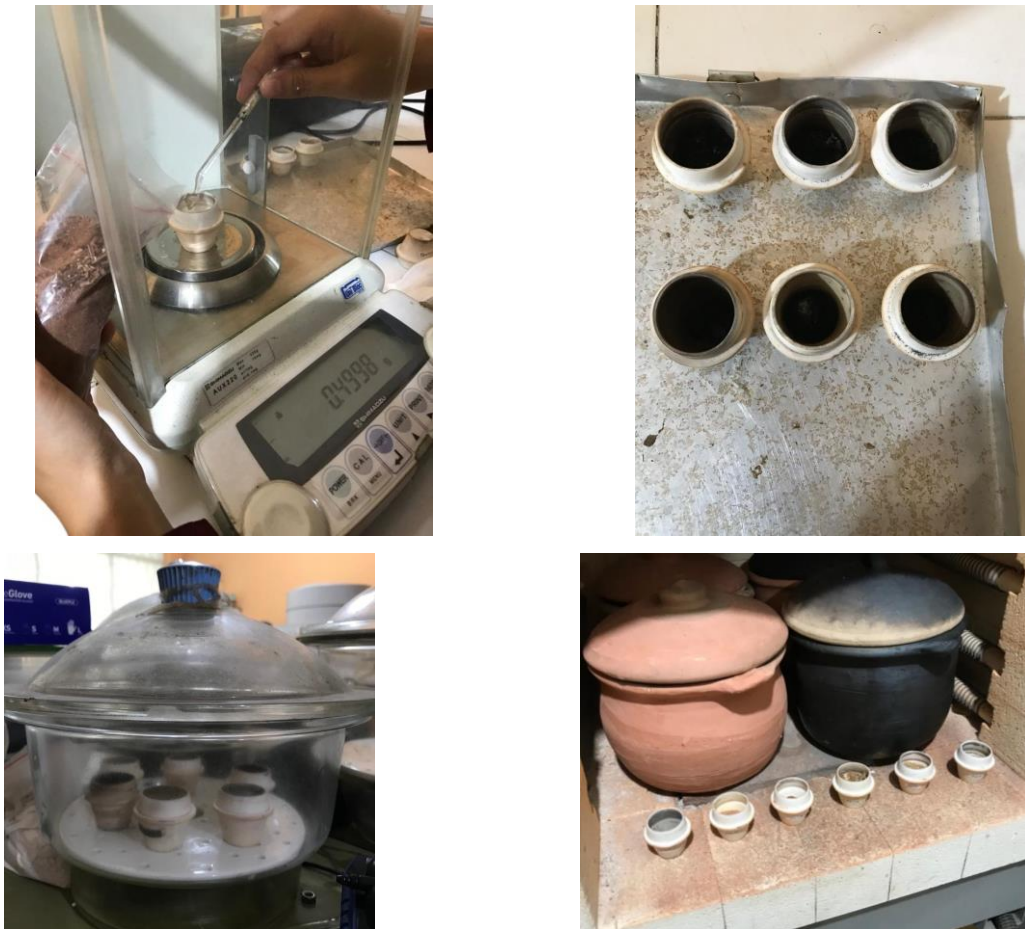
Gambar LIII.5 Proses Pengecekan Kadar Abu
