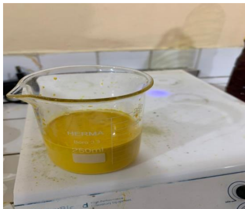
Gambar C. 10 Pencampuran Binder , Filler , dan Pelarut
