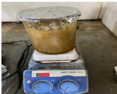
Gambar C.5 Delignifikasi & Ekstraksi Serat Batang Pisang
