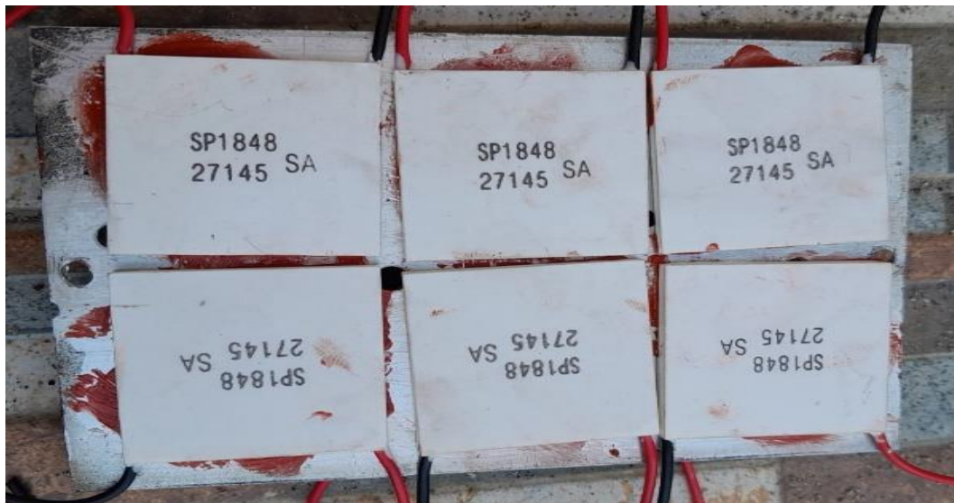
Gambar L3.13 Rangkaian TEG Disusun Seri
