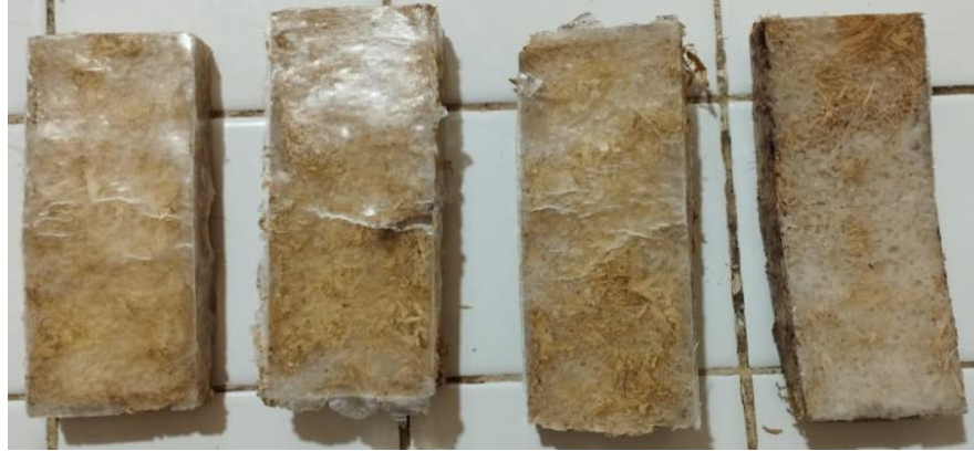
Papan serat dengan komposisi bahan 60 ampas tebu dan 40 perekat dengan variasi suhu 170 °C, 180 °C, 190 °C, dan 200°C
