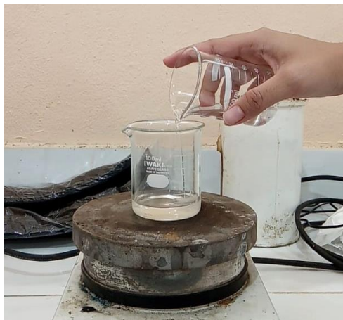
Gambar C.14 Menambahkan 18 ml Aquadest ke dalam asam stearate
