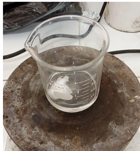
Gambar C.13 Memanaskan asam stearat sebanyak 11 gram dengan menggunakan Hot Plate
