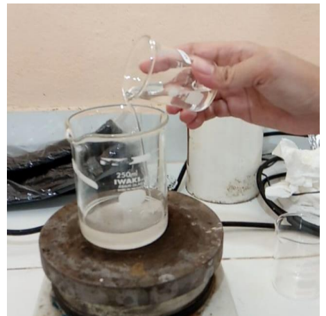
Gambar C.15 Menambahkan NaOH ke dalam VCO yang sudah dipanaskan
