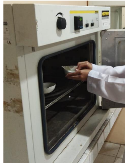
Gambar C.24 Analisis kadar air menggunakan oven selama 1 jam pada suhu 100°C
