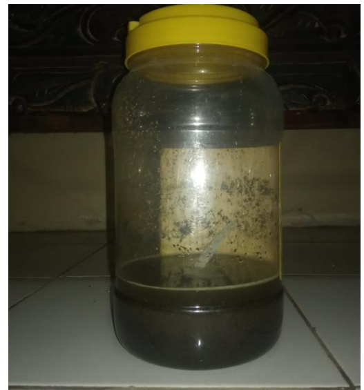
Gambar C.4 Menambahkan etanol 96% dengan perbandingan 1:3 dan dilakukan maserasi selama 3 hari
