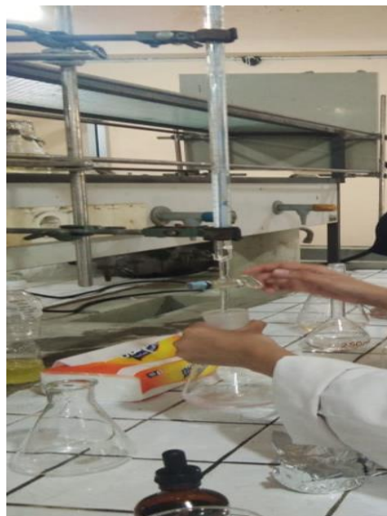
Gambar C.25 Analisis Asam Lemak Bebas dengan melakukan titrasi menggunakan larutan KOH 0,1 M dan analisis Alkali Bebas dengan melakukan titrasi menggunakan larutan HCl 0,1 M
