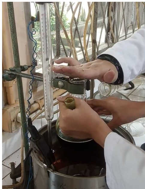
Gambar C.7 Melakukan distilasi pada suhu \pm 80^{\circ}\text{C} selama 1,5-2 jam
