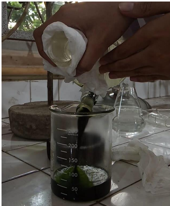
Gambar C.9 Hasil ekstrak daun kemangi dipindahkan ke dalam gelas kimia dan disimpan di dalam wadah tertutup
