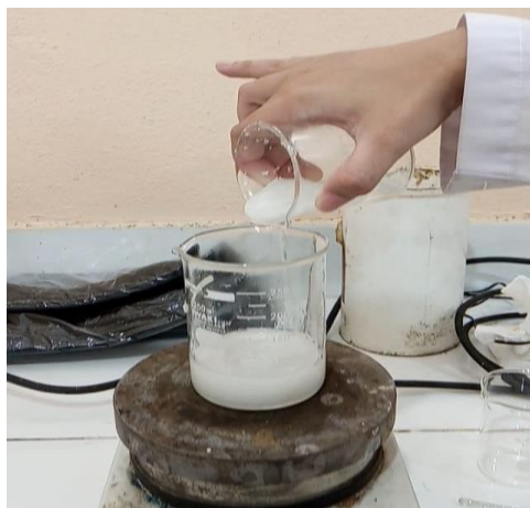
Gambar C.16 Memasukkan larutan asam stearat dan aquadest kedalam campuran VCO dan NaOH dan dilakukan pengadukan
