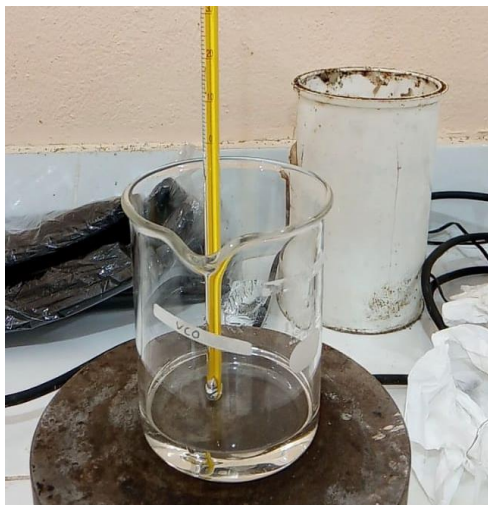
Gambar C.12 VCO 28 ml dipanaskan dengan menggunakan Hot Plate hingga suhu 70^{\circ}\text{C}
