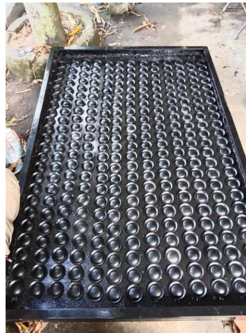
Gambar 16. Pemasangan Buntut Kaleng Pada Panel
