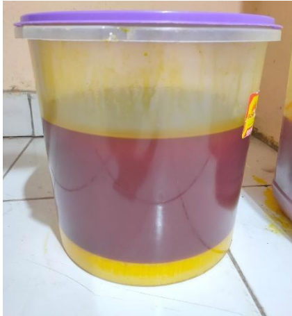
Proses Pengendapan Minyak Selama 1 jam
