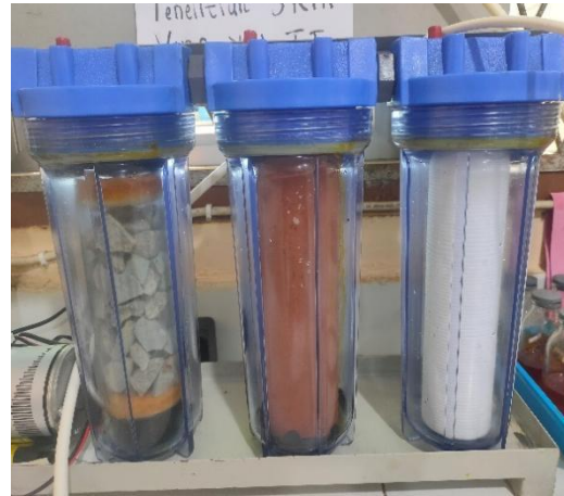
Proses Filtrasi dengan Zeolit, Membran dan Catridge
