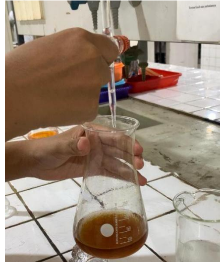
Analisis Bilangan Peroksida dengan metode titrasi
