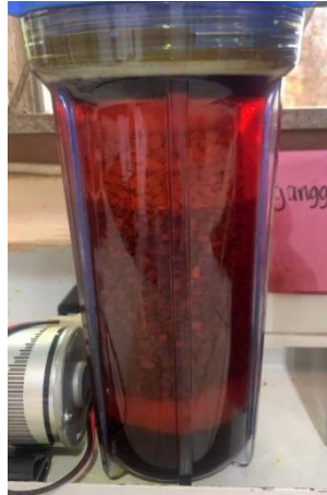
Proses adsorpsi menggunakan Zeolit
