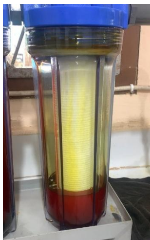
Proses Filtrasi dengan cartridge
