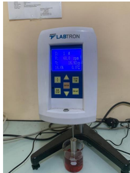
Analisis Viskositas menggunakan alat digital Labtron
