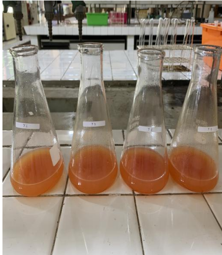
Analisis ALB dengan metode titrasi
