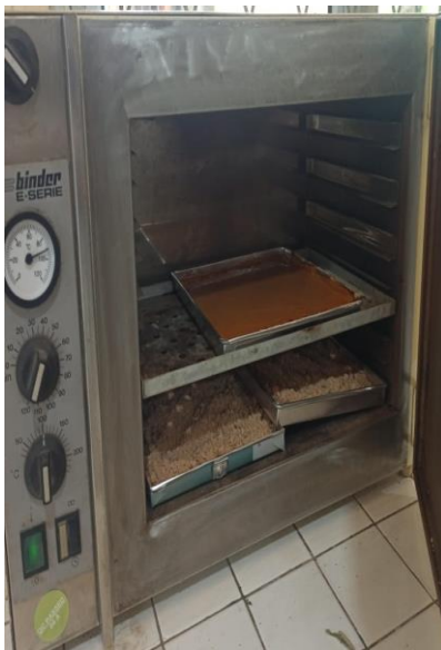
Pengeringan pati di oven selama 6 Jam dengan suhu 80 °C
