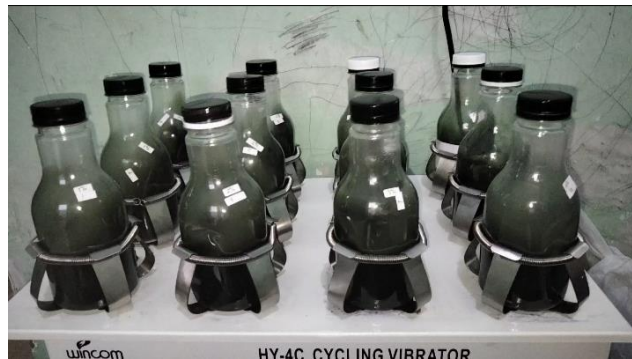
Tahap Pencampuran dan Pengadukan Konstan pada 150 rpm Selama 24 Jam
