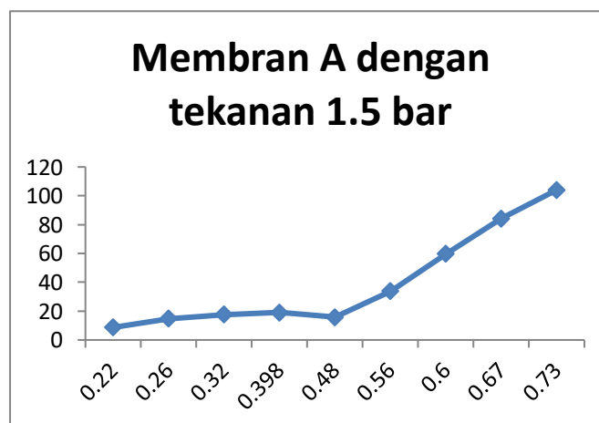
Gambar 25. Grafik nilai fluks membran A dengan tekanan 1.5 bar
