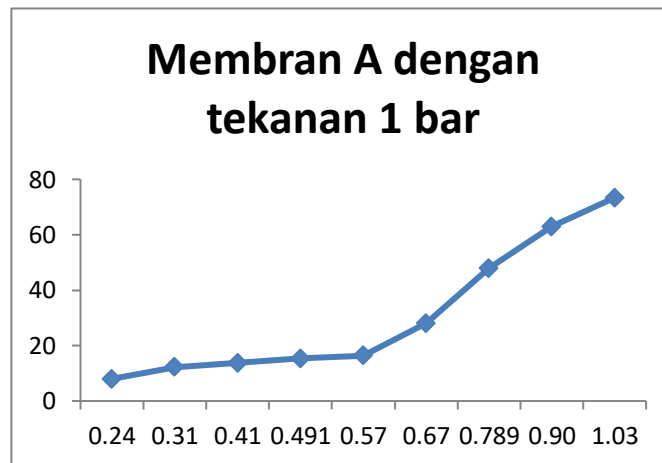
Gambar 24. Grafik nilai fluks membran A dengan tekanan 1 bar
