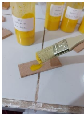
Gambar C.11 Uji Waktu Kering
