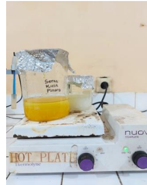
Gambar C.7 Bleaching Sampel Serat Kulit Buah Pinang
