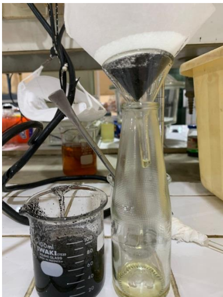
Gambar C.17 Proses Adsorpsi Minyak Jelantah menggunakan adsorben karbon aktif
