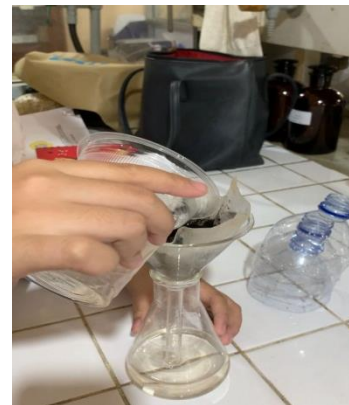
Gambar C.8 Pencucian bahan penyaringan komposit hingga Ph netral
