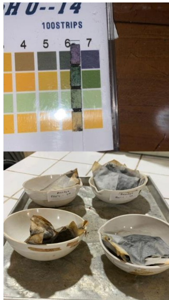
Gambar C.9 Setelah dicuci filtrat cukup jernih dan mempunyai pH 7, komposit diambil dan dipisahkan dari filtrate
