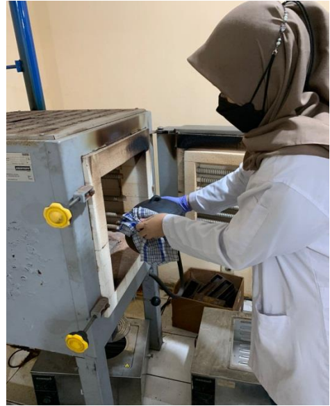
Gambar C.2 Proses karbonisasi Ampas tebu pada suhu 500 °C dan 800 °C
