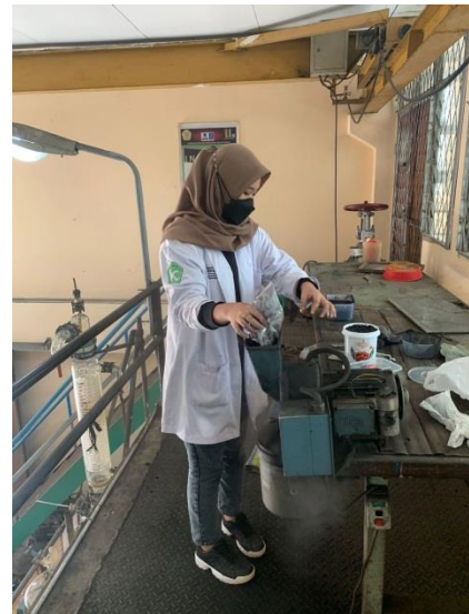
Gambar C.4 Penghalusan karbon dengan alat grinding
