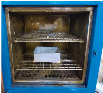
3) Memasukkan kedalam loyang dan dioven selama 3 jam
