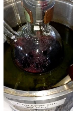
6) Proses distilasi ekstrak bayam merah
