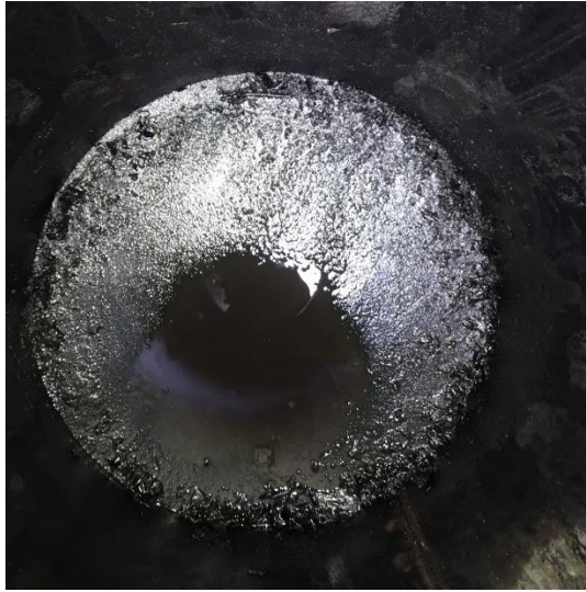
Gambar L3.5 Residu dan lilin yang terbentuk
