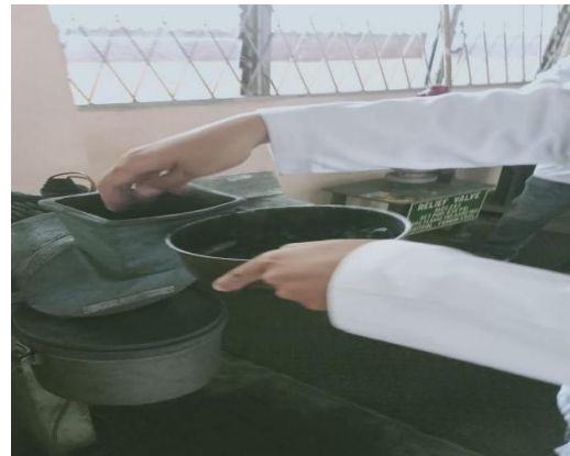
Grinding karbon yang telah di potong kecil-kecil
