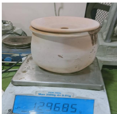
Memasukkan potongan plastik ke dalam kendi dan menimbang sebanyak 250 gr Kemudian dilakukan karbonisasi
