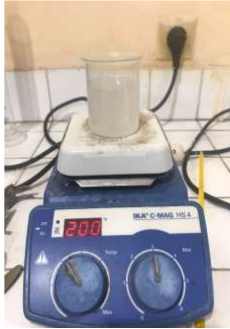
Gambar C.11 melarutkan PVA dengan aquadest pada suhu 100°C diatas hot Plate pada suhu 200°C.
