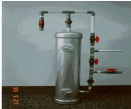
Gambar 2.7 Hasil Rancangan Alat Filter Yang Telah Siap Digunakan Berupa Target Luaran.
