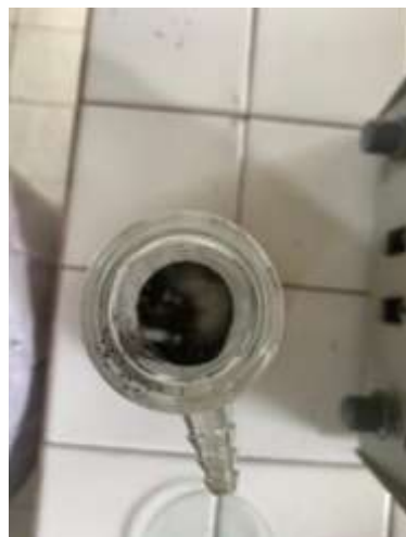
Gambar 11. Dimasukkan katalis Ni, Al dan Fe ke dalam erlenmeyer vacuum
