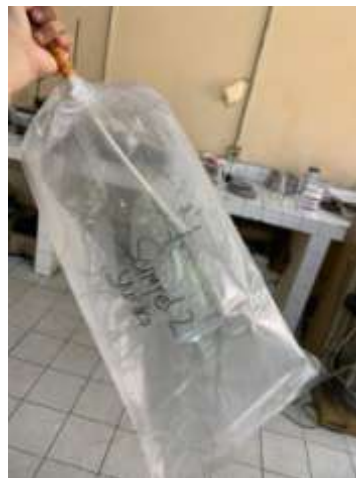
Gambar 17. Hasil gas yang didapatkan selama 60 menit siap untuk diuji Multi Gas Detector Analyzer
