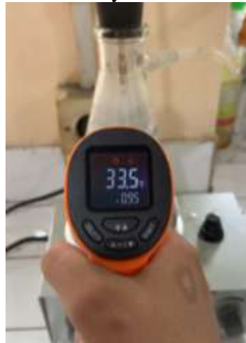
Gambar 16. Diukur Suhu campuran tiap 5 menit menggunakan termogun
