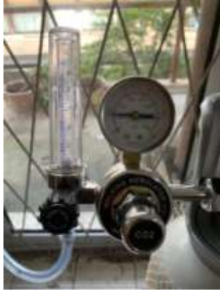
Gambar 1. Dipasang regulator pada Tabung gas CO 2
