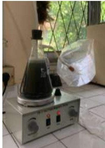
Gambar 15. Dipanaskan campuran dengan kecepatan 100 rpm selama 60 menit menggunakan hot plate
