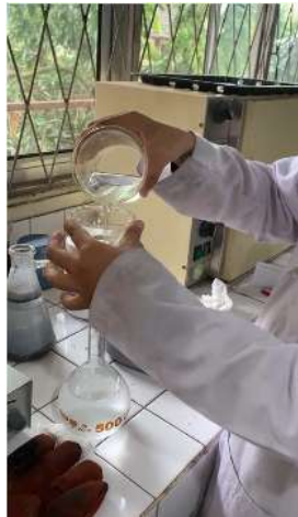
Gambar 8. Dimasukkan ke dalam Labu ukur 500 mL
