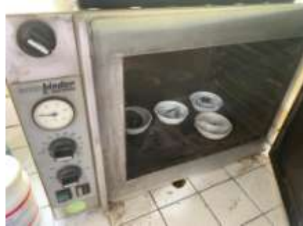
Gambar 19. Endapan dikeringkan di dalam oven selama 4 jam pada suhu 100°
