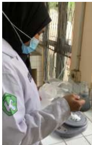
Gambar 6. Ditimbang Natrium Hidroksida (NaOH) sebanyak 20gr
