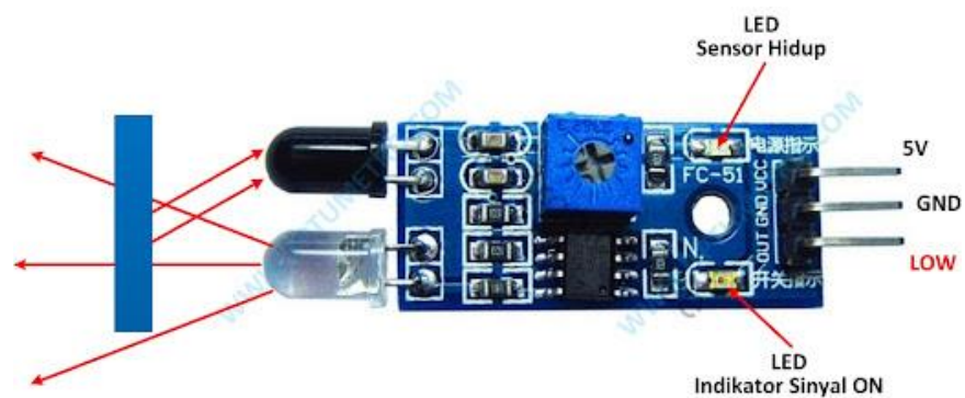
Gambar 2.7 Infrared Saat Ada Benda
