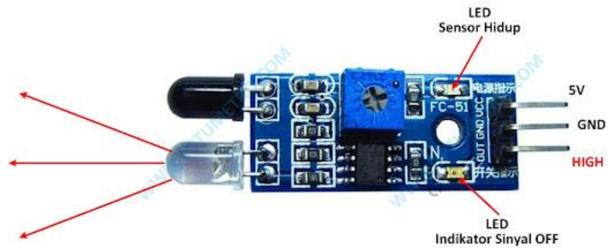
Gambar 2.6 Infrared Saat Tidak Ada Benda
