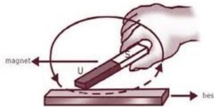
Gambar 2. 15 Magnet Tetap yang Menginduksi Besi
