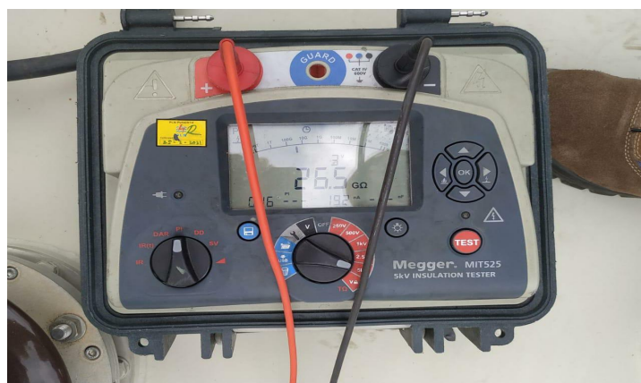
Gambar 2.4 Alat ukur tahanan isolasi
