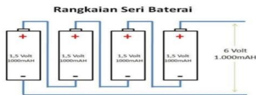
Gambar 2.23 Rangkaian Seri Baterai
