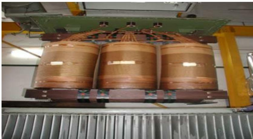
**Gambar 2.7** Kumparan atau Belitan Transformator
