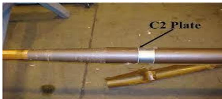
**Gambar 2.9** Konduktor Bushing Dilapisi Kertas Isolasi
