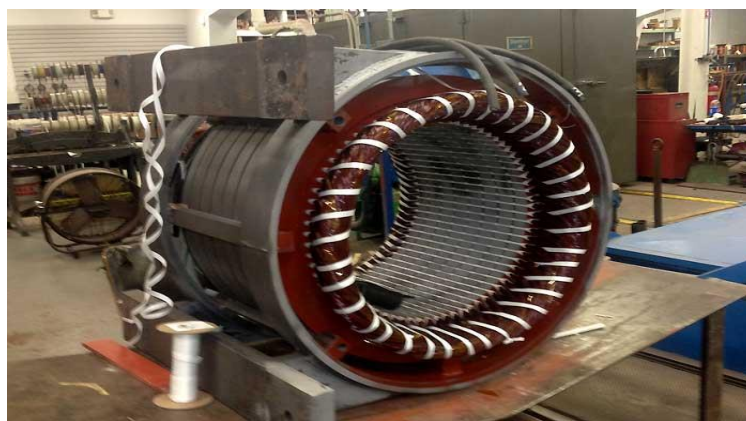
Gambar 2.9 Konstruksi stator jenis random-wound stator .
