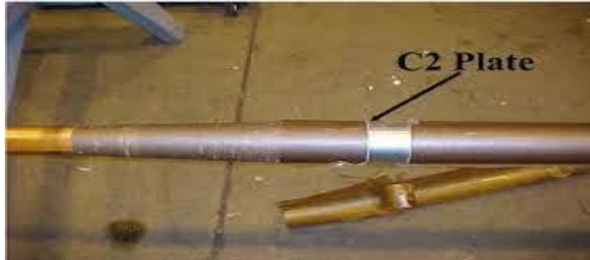
Gambar 2.7 Konduktor Bushing Dilapisi Kertas Isolasi
