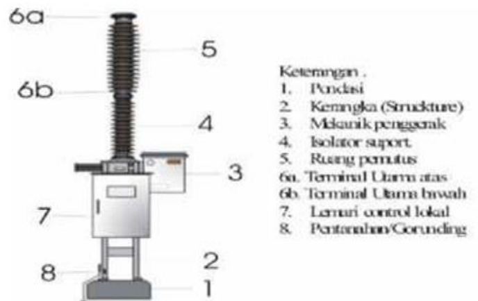
Gambar 2.5 Bagian – Bagian Utama PMT
