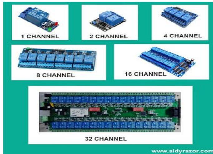
Gambar 2.28. Contoh – Contoh *Module Relay*
