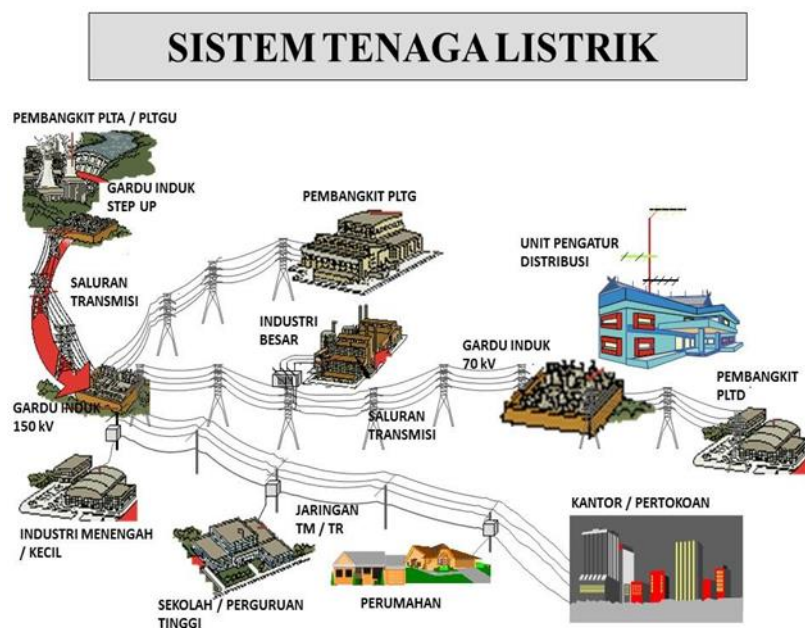
Gambar 2. 1 Sistem Tenaga Listrik
