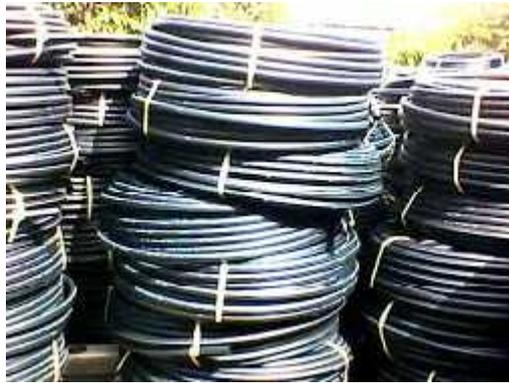
Gambar 2.2 Metode Penyusunan Pipa HDPE
