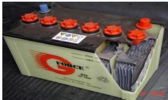
**Gambar 2.17** Konstruksi Baterai Stater
