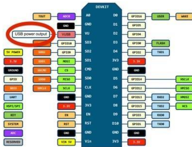
Gambar 2.18 GPIO NodeMCU ESP8266 v3 [4]
