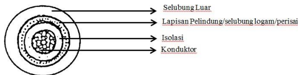
Gambar 2.16 Bagian-bagian kabel berinti tunggal
