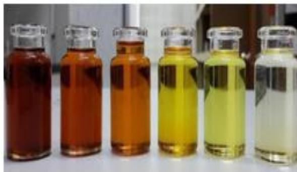
Gambar 2.4 Minyak Transformator
