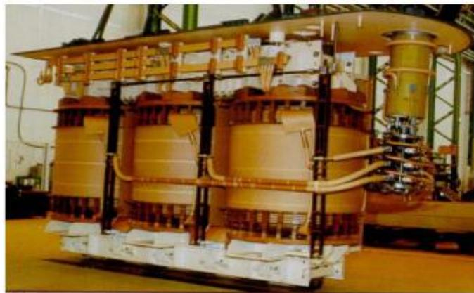
Gambar 2.3 Kumparan Transformator
