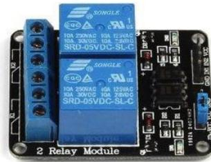
**Gambar 2.13** Module Relay 5V tipe 2Channel <sup>[9]</sup>
