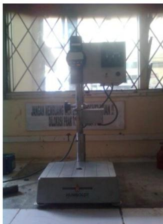
Gambar 2.9 Alat Penetrasi Aspal
