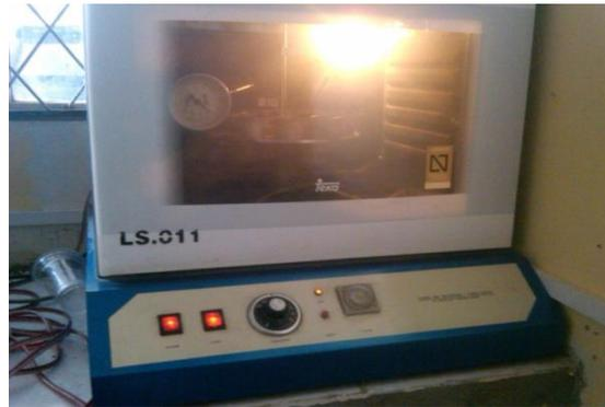
Gambar 2.13 Oven Pengujian Kehilangan Berat Aspal
