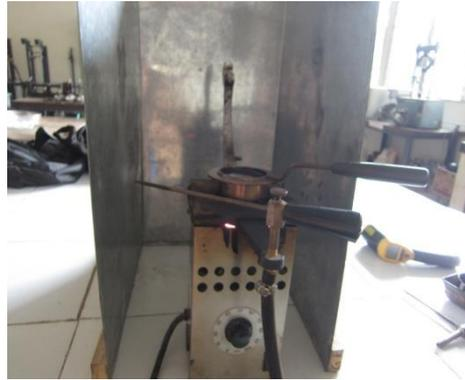
Gambar 2.11 Alat Pengujian Titik Nyala dan Titik bakar
