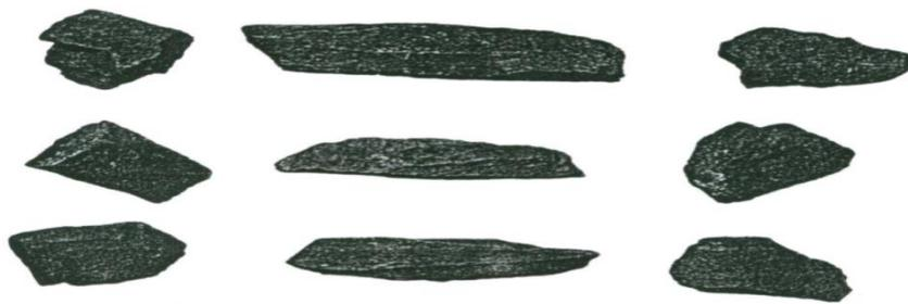
Gambar 2.5 Bentuk-Bentuk Agregat
