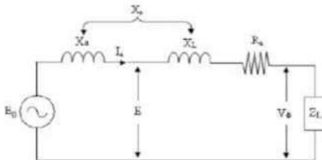
**Gambar 2.6** Rangkaian Ekuivalen Generator Sinkron Berbeban<sup>5</sup>
