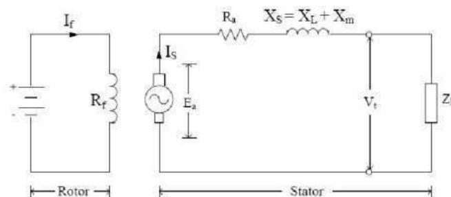
**Gambar 2.5** Rangkaian Ekuivalen Generator Sinkron Tanpa Beban
