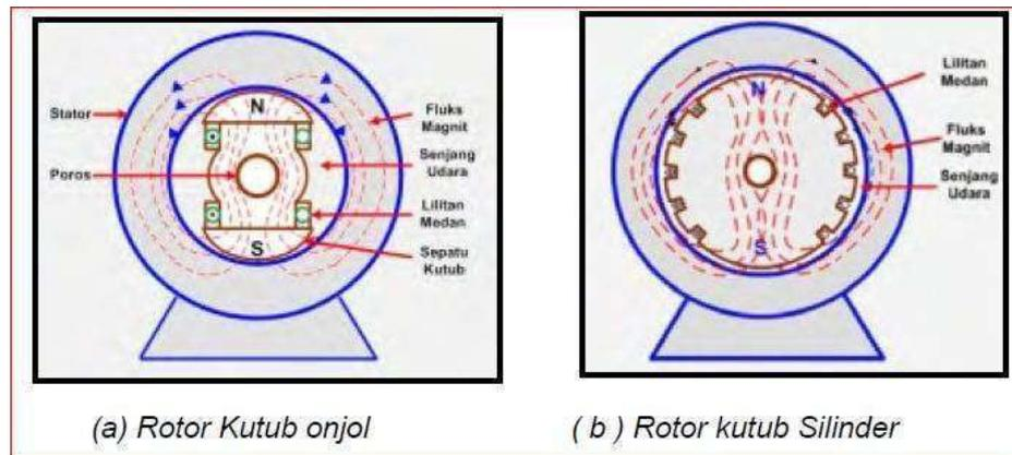
**Gambar 2.3** (a) rotor kutub tonjol dan (b) rotor kutub silinder<sup>3</sup>
