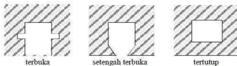
**Gambar 2.4** Macam alur jangkar pada stator
