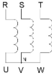
**Gambar 2.1** Ujung-ujung kumparan stator generator sinkron
