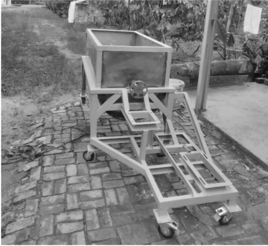
Gambar 7.25 Hasil Pengecetan Dasar E-Poxy
