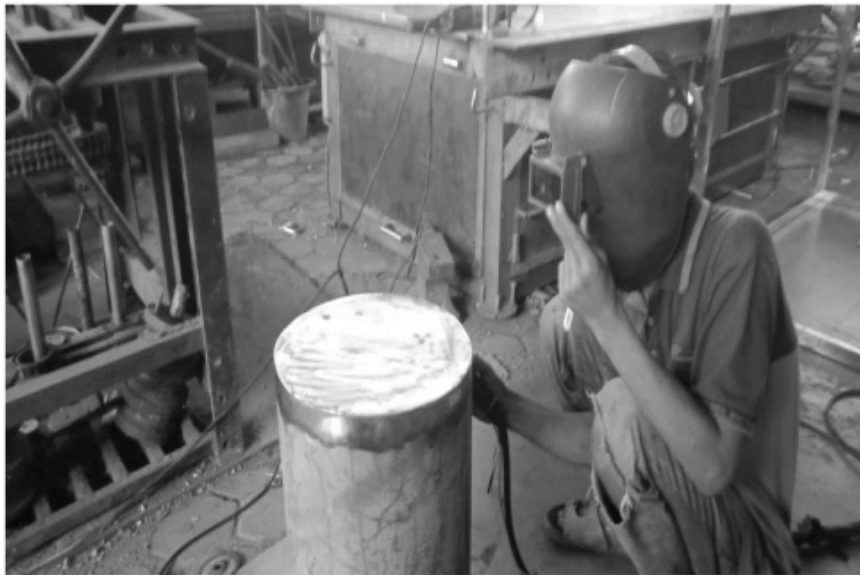
Gambar 7.6 Perakitan Tutup Bawah
