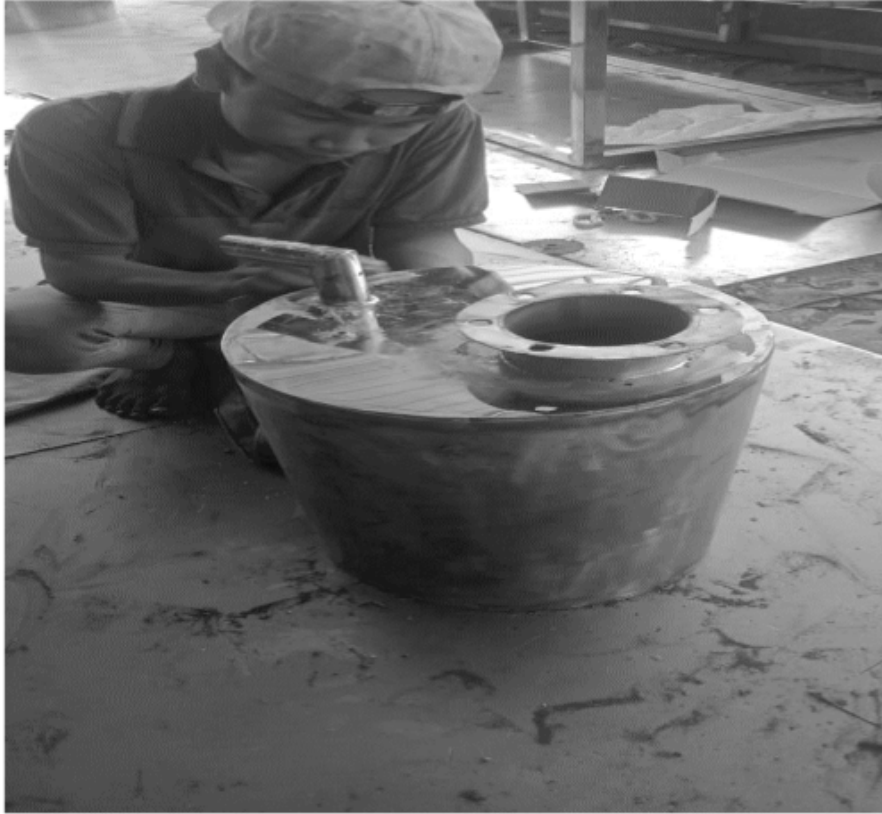
Gambar 7.5 Perakitan Tutup Atas
