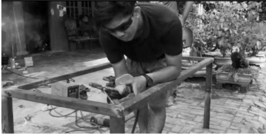
Gambar 7.22 Proses Penyatuan Kerangka.
