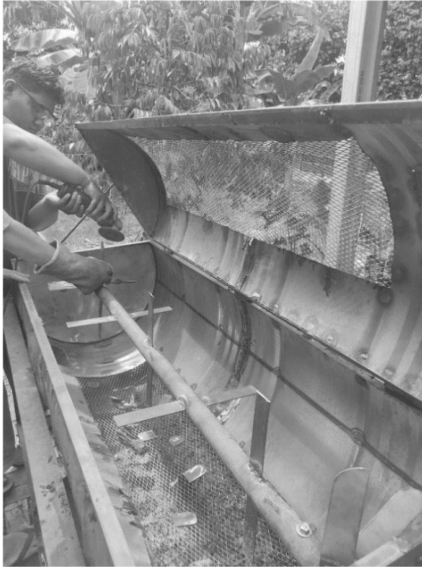
Gambar 7.34 Proses Pembuatan Sudu
