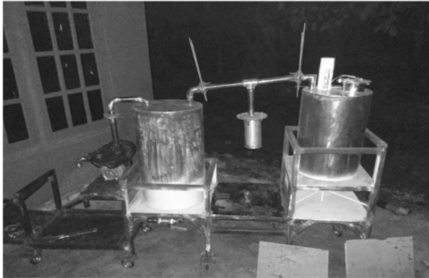
Gambar 7.16 Menyambungkan Reaktor Ke Kondenser
