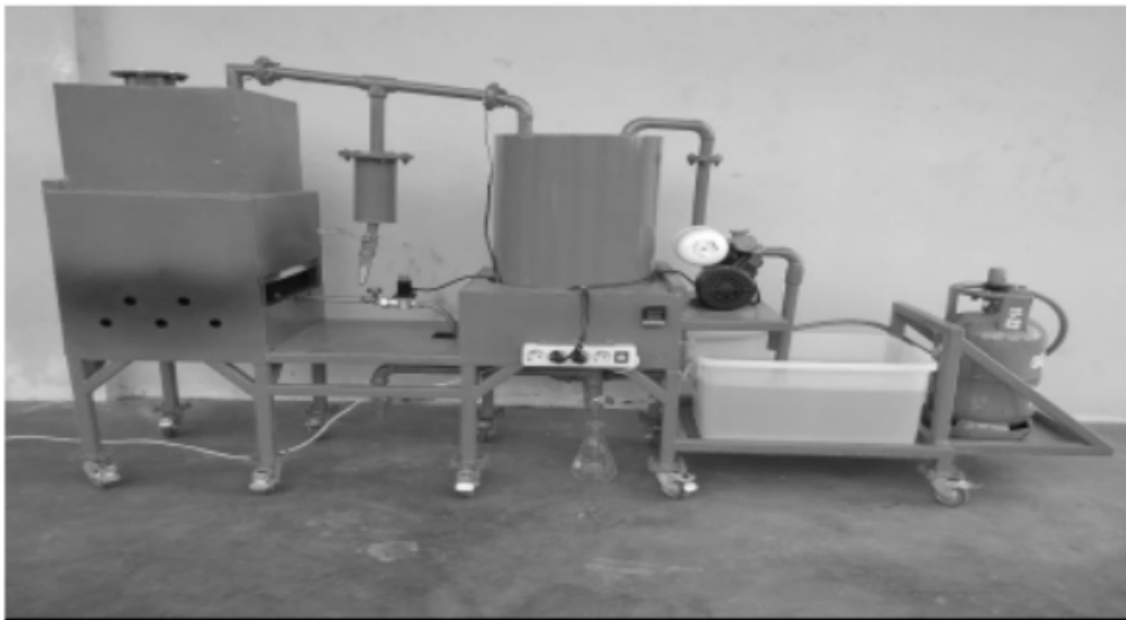
Gambar 7.19 Alat Pirolisis Limbah Kantong Plastik Kapasitas 2,5 Kg
