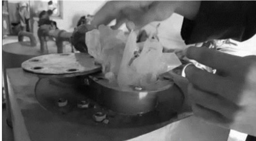
Gambar 8.19 Memasukkan Limbah Kantong Plastik Ke Reaktor
