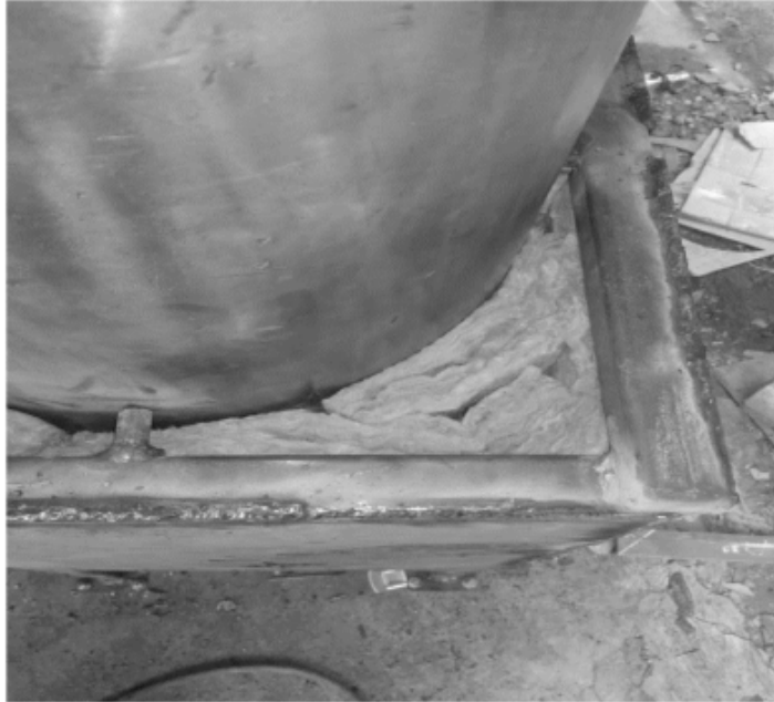
Gambar 7.7 Mengisolasi Reaktor dengan GlassWool
