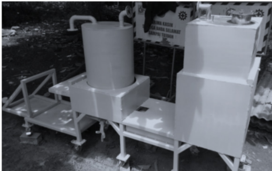
Gambar 7.17 Pengecatan Dasar Alat Pirolisis
