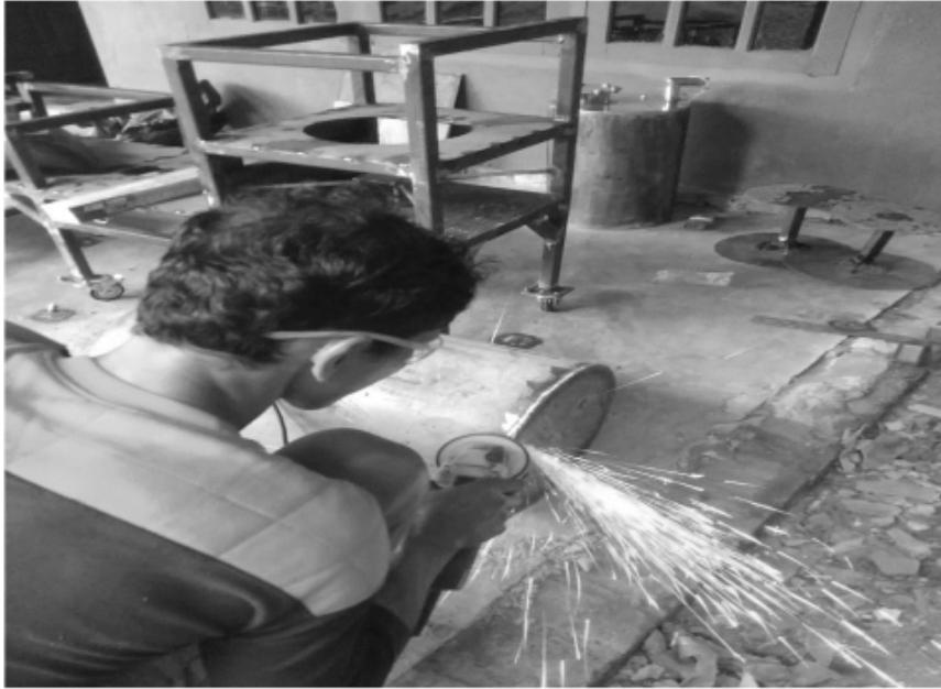
Gambar 7.12 Merapikan Hasil Las dengan Menggunakan Gerinda
