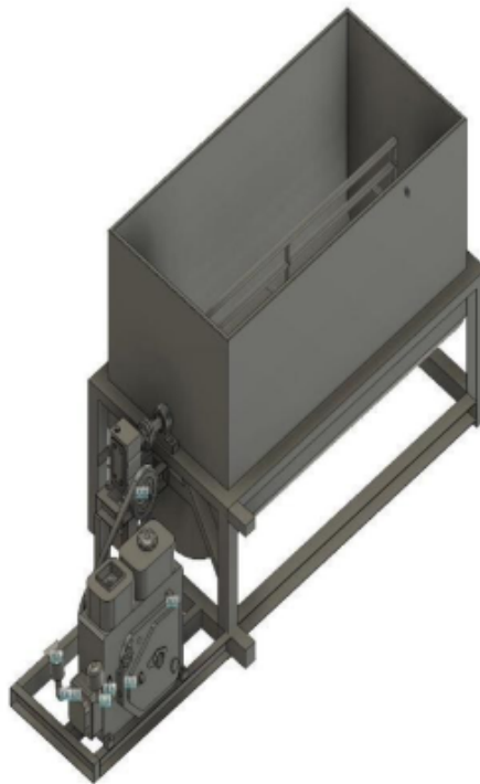
Gambar 7.20 Desain 3D Mesin Pencuci Limbah Plastik.
