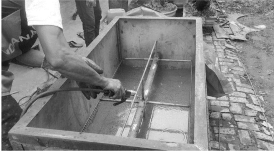
Gambar 7.24 Proses Membuat Sudu Pencuci.
