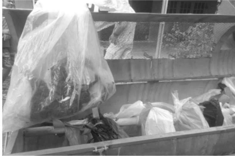
Gambar 8.16 Limbah Kantong Plastik Kering yang Keluar Dan yang Tersisa Di Bak Pengereng
