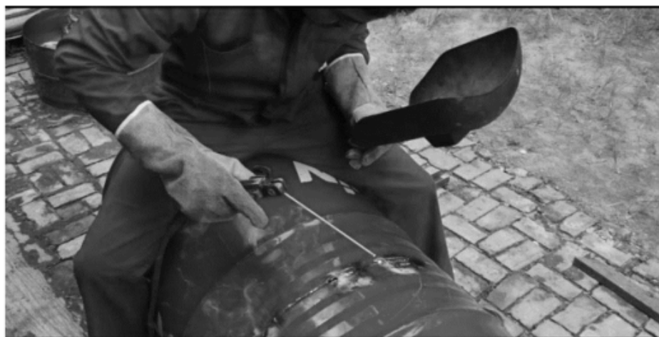
Gambar 7.31 Penyambungan Drum Besi
