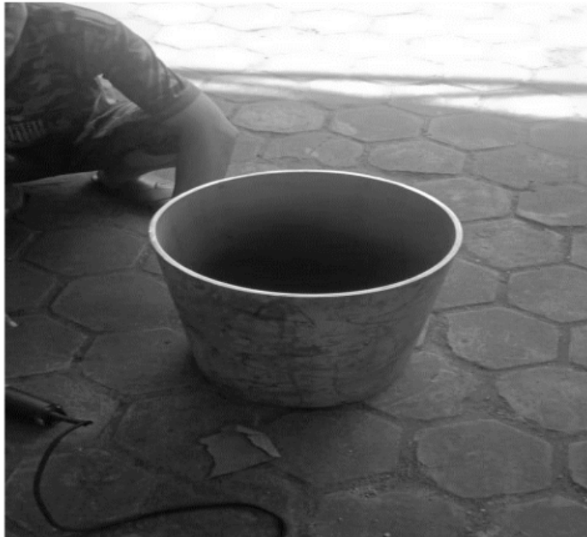
Gambar 7.2 Pipa Stainless Stell Bahan Tabung Kondensor
