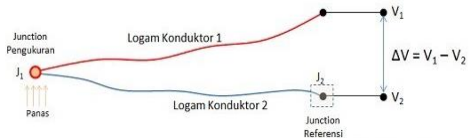
Gambar 2.33 Cara Kerja Thermocouple
