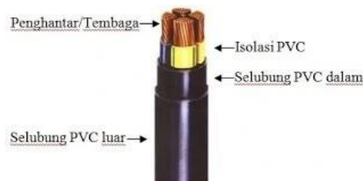
Gambar 2. 10 Konstruksi Kabel NYY
