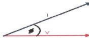
Gambar 2. 33 Arus mendahului dari tegangan sebesar sudut \phi
