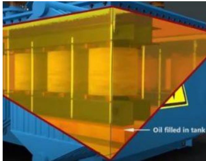
*Gambar 2. 9 Minyak Transformator*
