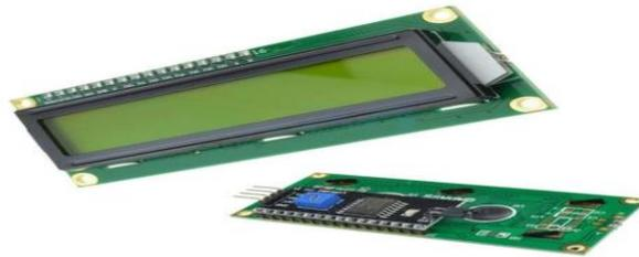
**Gambar 2.10** LCD 16x2 digabung dengan I2C<sup>[9]</sup>
