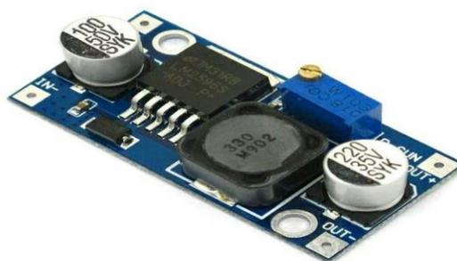
**Gambar 2.7** Modul Step Down LM2596<sup>[8]</sup>
