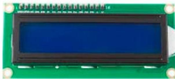
Gambar 2. 19 2.19 Lcd 16x2
