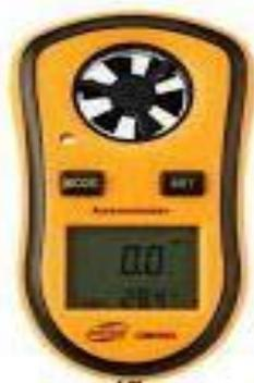
*Gambar 2. 15 Anemometer*
