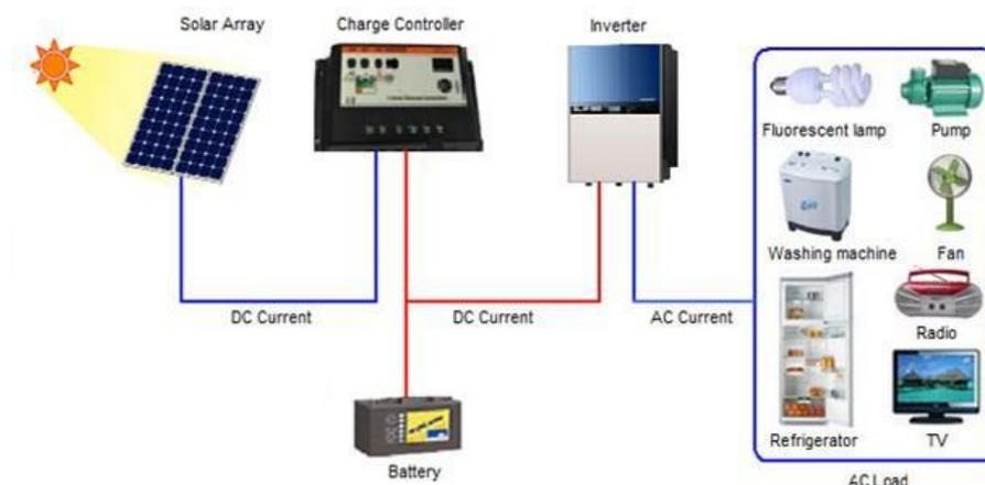
**Gambar 2. 2** Sistem Pembangkit Listrik Tenaga Surya
