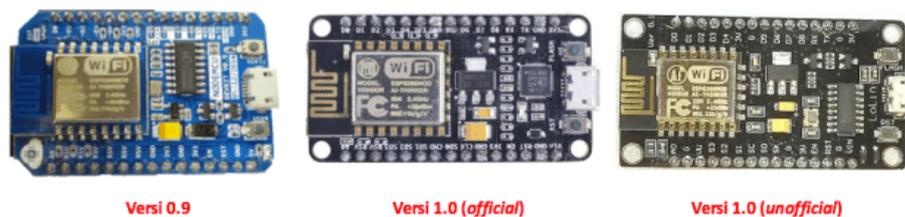
Gambar 2.5 Versi NodeMCU ESP8266<sup>[8]</sup>
