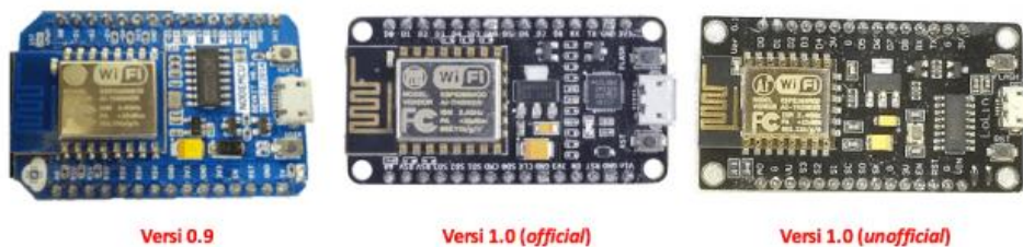
Gambar 2.7 Versi Mikrokontroler NodeMCU ESP8266 [7]
