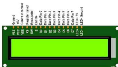
**Gambar 2.12 Susunan Pin LCD** <sup>[11]</sup>
