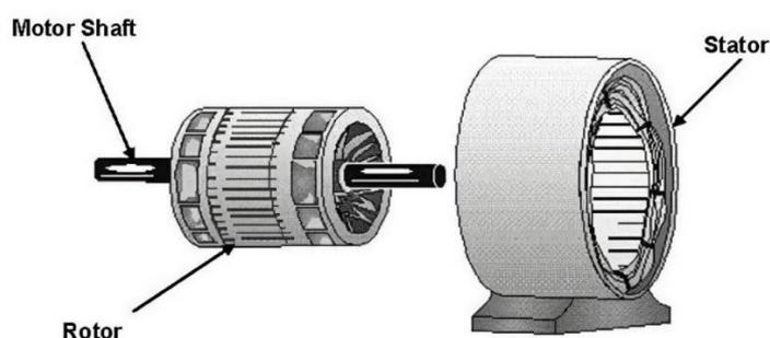
**Gambar 2.7 Rotor dan Stator** <sup>[8]</sup>
