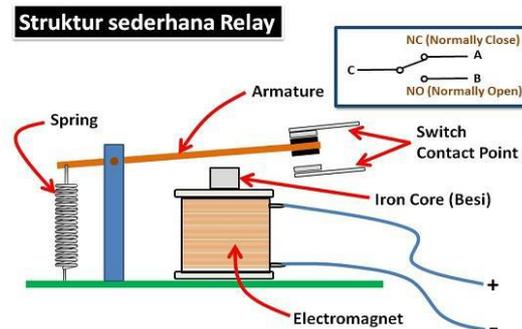
**Gambar 2.10 Struktur Relay<sup>[5]</sup>**
