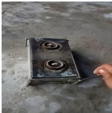
**Gambar 1.2** Alat Pencetak Batako *Interlock* (Pasha, 2022)
