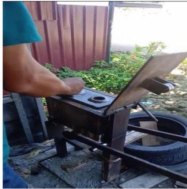
**Gambar 1.1** Alat Pencetak Batako *Interlock* (Pasha, 2022)
