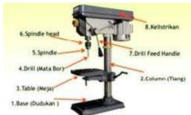
Gambar 2.7 mesin bor (Siregar *et al.*, 2018)
