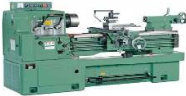
Gambar 2.8 mesin bubut (Siregar *et al.*, 2018)
