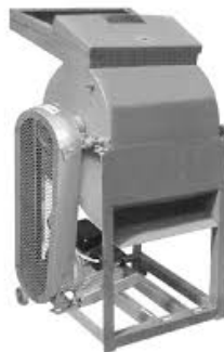
Gambar 2.5 Alat Pemipil Jagung Menggunakan Mesin Bakar (Rizki, 2022)
